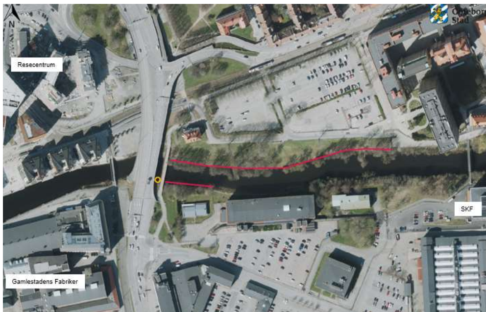
Figur 3. Karta över sökta åtgärder. Erosionsskydden illustreras med röd linje och läget på utloppet för dagvattenledningen illustreras med orange cirkel.
